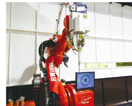
▲ファイバーレーザ溶接自動ロボットシステム
