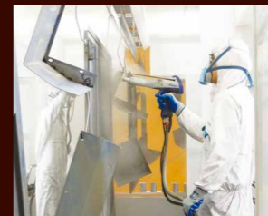
粉体塗装設備
