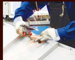
大型定盤を使った溶接
